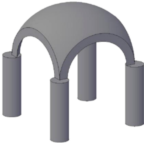
Figura 11. Schematizzazione dell'effetto arco.
